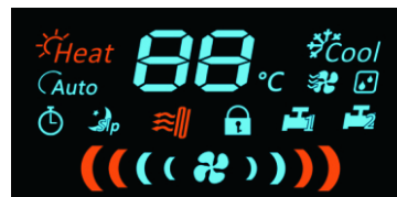
ВКЛ с режим на отопление и заключване на бутоните
